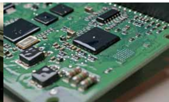
Upravljačke kartice sa zaštitnim premazom su pogodne za primenu u agresivnim sredinama.
